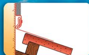
Sur façade à crépir POSITION STOP ENDUIT
